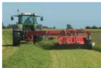
GMT L/Flex косилки могут быть оснащены дополнительным рудованием "Collector" для сдваивания валков.
