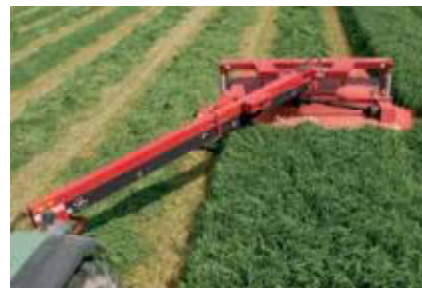
Flex машины оборудованы длинным и усиленным центральным дышлом.
